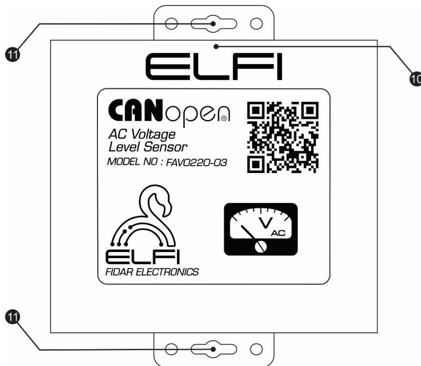
شکل ۳: نمای روبه روی Node سطح ولتاژ متناوب
