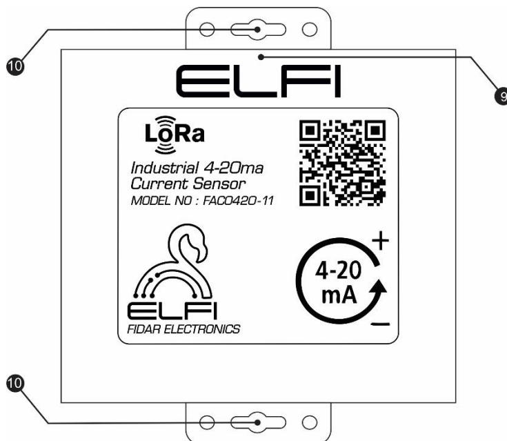
شکل ۳: نمای روبه روی Node ۲۰-۴ میلی آمپر تک کانال بی سیم
