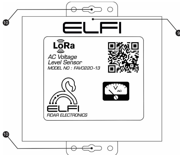
شکل ۳: نمای روبه روی Node سطح ولتاژ متناوب بی سیم
