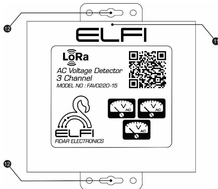
شکل ۳: نمای روبه روی Node دتکتور ولتاژ متناوب سه کانال بی سیم
