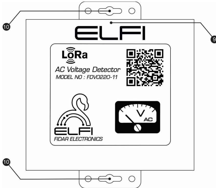
شکل ۳: نمای روبه روی Node دتکتور ولتاژ متناوب تک کانال بی سیم
