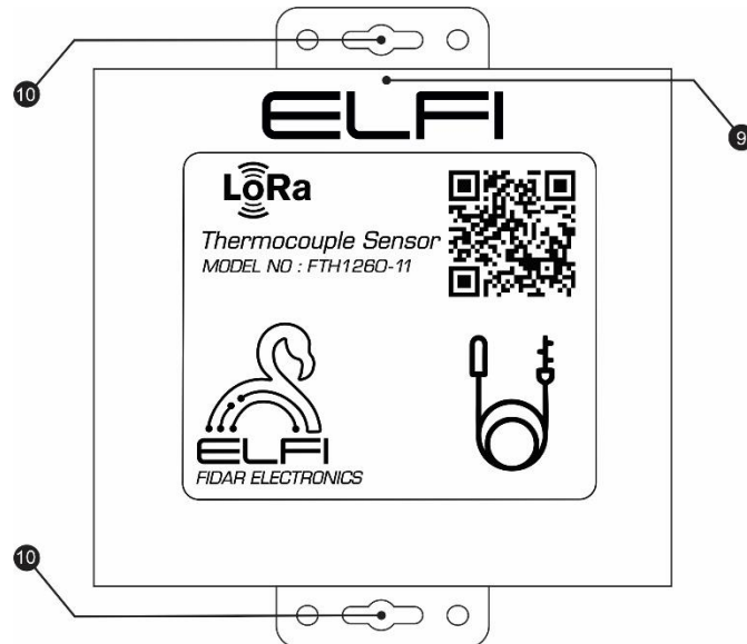
شکل ۳: نمای روبه روی Node ترموکوپل نوع K بی سیم
